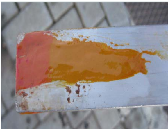
Fotografia onde é possível identificar a cor vermelha no fundo da vareta, indicador da presença de água em depósito de combustível
