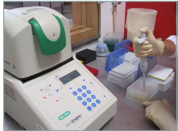
Inoculação do controlo positivo e DNA das amostras, para amplificação no termociclador
