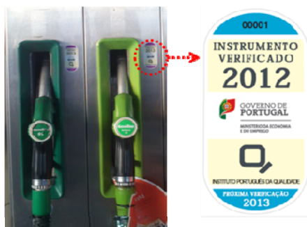
Fig.2: Sistemas de medição de quantidades de líquidos (bomba de combustível) e Etiqueta informativa utilizada no controlo metrológico
