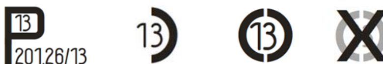
Fig. 4: Símbolos de Controlo Metrológico (Aprovação Modelo, Primeira Verificação Nacional, Verificação Periódica, Rejeição na Verificação Periódica)
