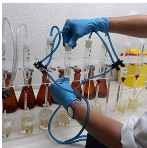
Figura 2 – Detalhe da concentração de aflatoxinas em colunas de imunoafinidade, análise de rotina
